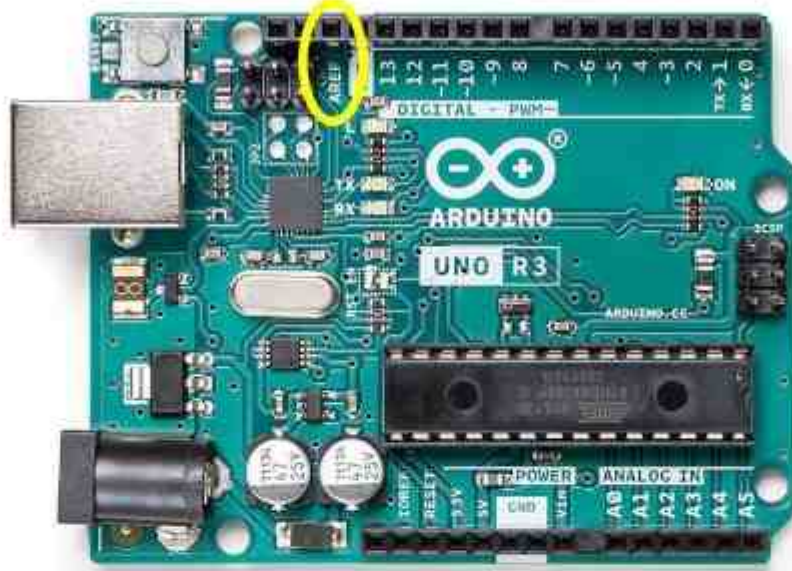
الشكل رقم (13) يوضح منفذ قطب الجهد المرجعي الخاصة بالاردوينو.
