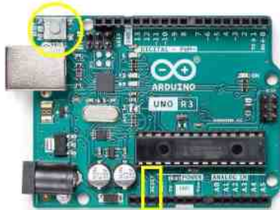
الشكل رقم (9) يوضح زر إعادة التشغيل الخاص بالاردينو.
