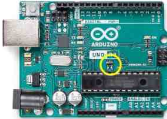
الشكل رقم (8) يوضح الهزازة الكريستالية الخاصة بالاردينو.
