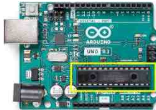
الشكل رقم (10) يوضح المتحكم المصغر الخاص بالاردوينو.
