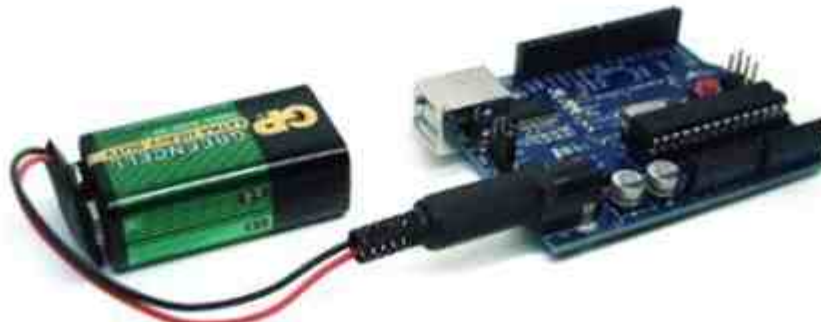
الشكل رقم (5) يوضح توصيل الاردوينو بالطاقة.
