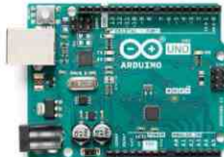
الشكل رقم (1) يوضح لوحة أردوينو أونو Arduino Uno
