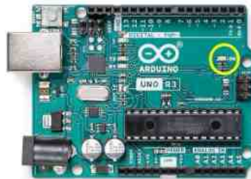
الشكل رقم (11) يوضح ليد مؤشر التشغيل الخاص بالاردوينو.
