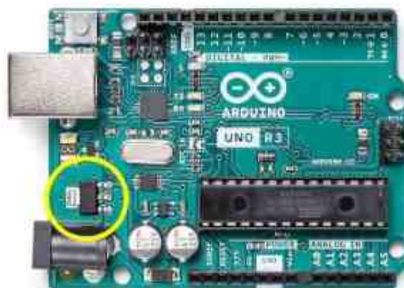
الشكل رقم (7) يوضح منظم الجهد الخاص بالاردوينو.
