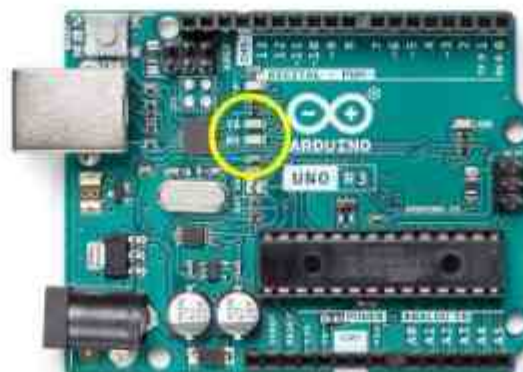
الشكل رقم (12) يوضح ليدات بروتوكولات الاتصال الخاصة بالاردوينو.
