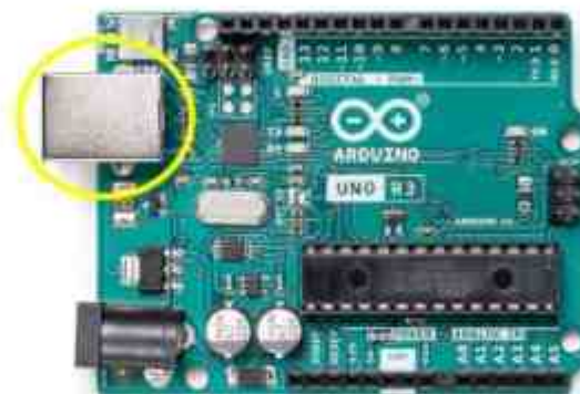
الشكل رقم (6) يوضح منفذ البرمجة الخاصة بالاردوينو.
