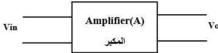
الشكل رقم (1) يوضح رمز المكبر بدون التغذية الراجعة
