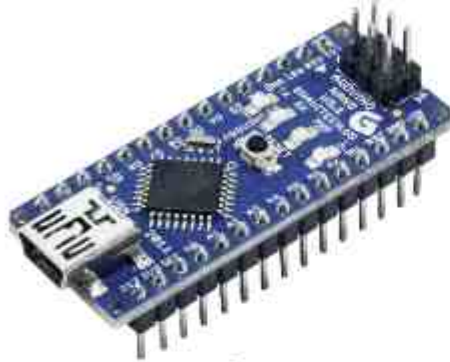
الشكل رقم (2) يوضح أردوينو نانو Arduino Nano
