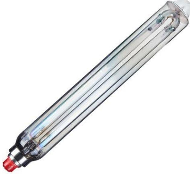
ومزودة عند كل طرف بفتيلة مكمسية بمادة انبعاثيه ، وعند التسخين يبدأ التفريغ فيظهر أولاً بلون أحمر برتقالي حتى ترتفع درجة الحرارة فيبدأ الصوديوم في عملية التفريغ ويتحول الضوء إلى الأصفر ، وتتراوح فترة بداية التشغيل حتى إعطاء الإضاءة الكاملة من 7 إلى 15 دقيقة ، وتتم المحافظة علي درجة الحرارة عن طريق العزل الحراري للأنبوبة .
