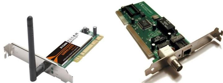
❖ **المودم Modem** : لوح يربط مع الحاسوب يستخدم في عملية (تضمين - فك التضمين) وهي عملية تحويل البيانات من الاشارات التماضية الى الاشارات الرقمية او العكس . يوجد نوعان من المودم (داخلي وخارجي )
