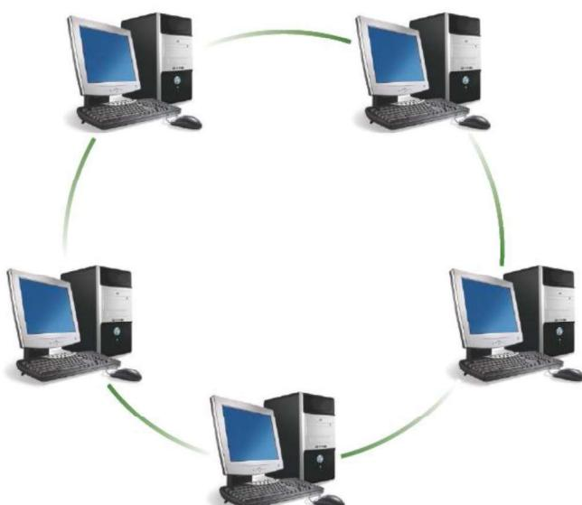
• **الشبكة الحلقة Ring network** يتم فيها وصل كل جهاز إلى جهازين آخرين مشكلاً حلقة، انظر الشكل (19-8).
